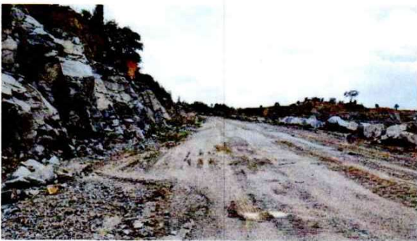
รูปที่ 5 เส้นทางถ้ำเลียงแร่ ทำหน้าที่เสมือนคันทำนบเบี่ยงเบน น้ำให้ไหลลงสู่บ่อดักตะกอน
