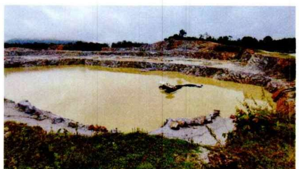
รูปที่ 6 บ่อดักตะกอนดินบริเวณหน้าเหมือง ก่อนระบายสู่บ่อดักตะกอน
